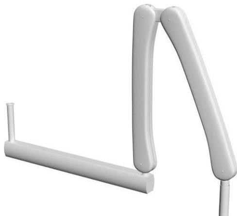
Das Gerät wird in der Installationsumgebung mit Hilfe eines Doppelpantographen-Gelenkarms geführt; dieser Arm, der über eine Verlängerung mit variablen Abmessungen (400-800-1100 mm) an der Wandhalterung befestigt ist, hat eine maximale Ausladung, die je nach verwendeter Verlängerung zwischen 1730 und 2430 mm variiert.
